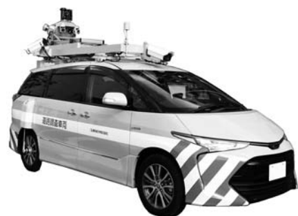
MMSレーザースカナ搭載車両
