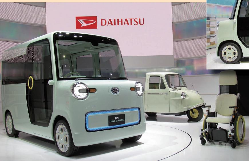
「DN PRO CARGO」。小回りと使い勝手のよさを追求した配達用のコンセプト軽自動車で、1950～60年代に活躍したオート3輪車「ミゼット」(後方)の、いわば「次世代版」。車体左サイドには大きなドアを配して荷物の積み下ろしを便利にした他、車体後部にはリフトも設置、車椅子の収納も可能としている。
