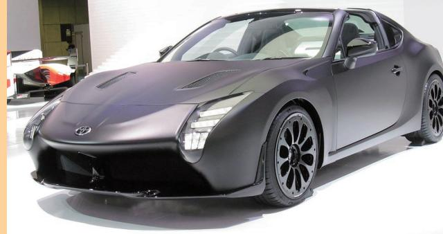
「GR HV Sports Concept」。ハイブリッド・システム「THS-R (TOYOTA Hybrid System-Racing)」を搭載したFR/2シーター・スポーツのコンセプトカー。伝説の「トヨタスポーツ800」(トヨハチ)からのデザイン・コンセプトを匂わせるフォルムだ。
