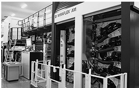
無溶剤水性インキを使うC型水性フレキシソ印刷機
