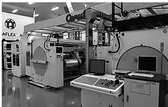
環境配慮型のノンソルベルト・ラミネータ
