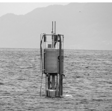
WETが神戸港沖で実証実験したフロート型波力発電装置（WET）
